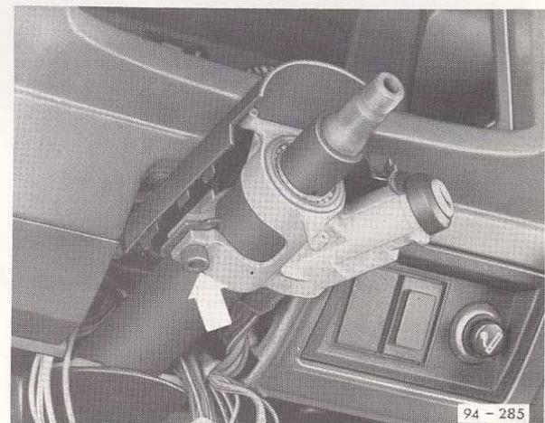
**Fig. 5 Dépose de l'antivol de direction**
