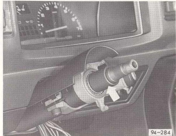
**Fig. 4 Dépose de la douille entretoise du tube de direction**
